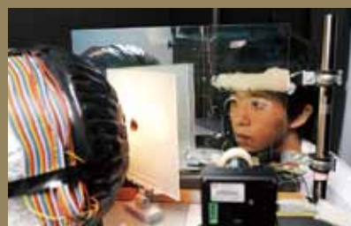
光源装置の前に顔を固定し、光を照射。その際の瞳孔反応を測定する
